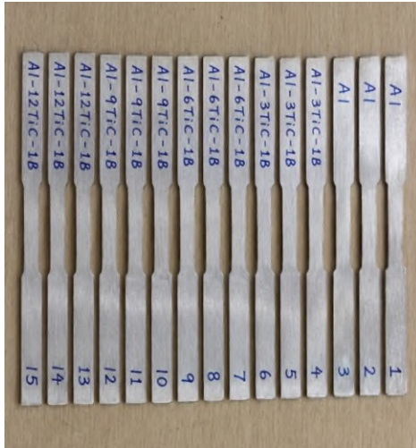
Fig. 3a. Tensile test specimens
